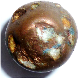
Зображення 8. Форма передньої частини кулі та відображення на ній слідів при ударі її об перешкоду під кутом близьким до 80°.
