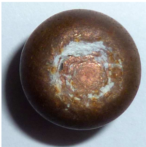
Зображення 9. Форма передньої частини кулі та відображення на ній слідів при ударі її об перешкоду під кутом близьким до 90°.
