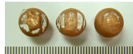
Зображення 7. Сліди на передніх частинах куль при їх проходженні через загартоване бокове автомобільне скло під кутом близьким до 80° в такій послідовності :справа – перша, в центрі – друга, зліва - третя.
